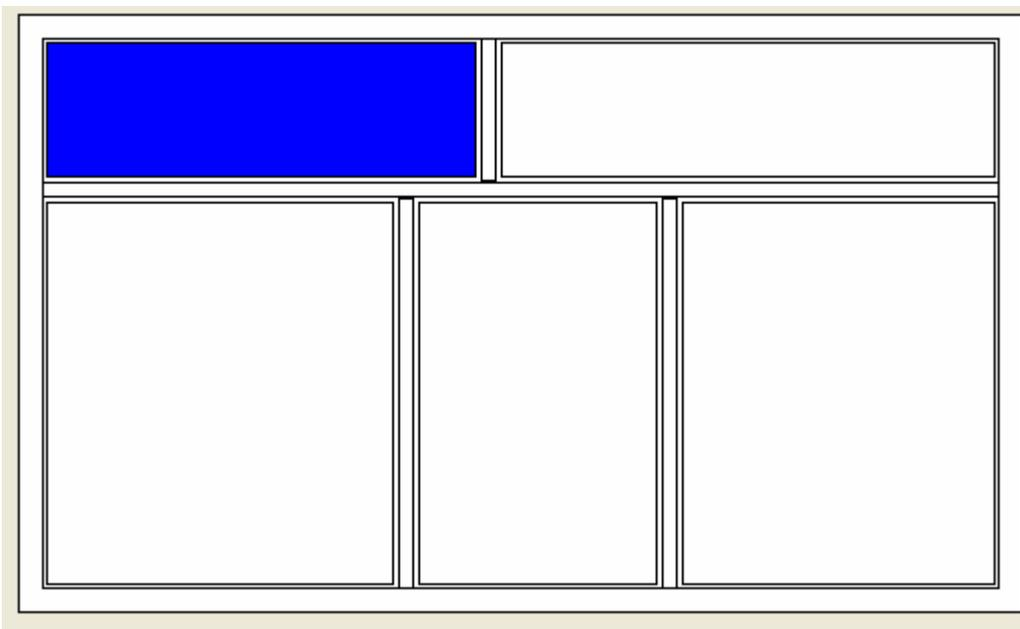
Выбирая поочередно все секции конструкции, необходимо настроить параметры секций: открывание(правое, левое, без открывания), проветривание, наличие москитной сетки, размеры секции (высота и ширина), стеклопакет. При изменении размеров секции и стеклопакета подтвердить изменения с помощью кнопки «Применить»
