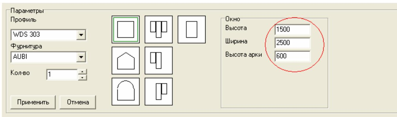
Впоследствии изменить начальные параметры конструкции можно, выбрав пункт контекстного меню (вызывается нажатием правой клавиши мышки на списке конструкций) «Изменить нач. параметры» и выбрать в открывшейся вкладке требуемые параметры.
