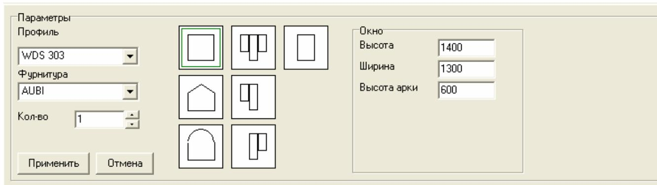
на основании которой будет происходить конструирование окна (балконного блока, входной двери), и задать необходимые параметры: профиль, фурнитура, количество изделий, основные размеры конструкции, после чего подтвердить выбор кнопкой «Применить».
